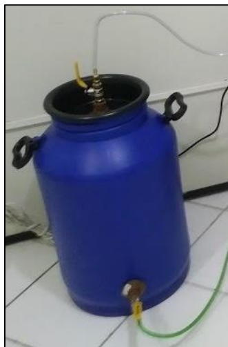
Figura 1. Legenda: Tambor de PVC com válvulas de gás.
